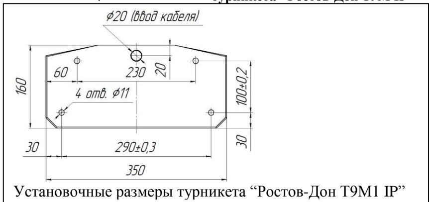
Габаритные размеры турникета "Ростов-Дон Т9М IP"
