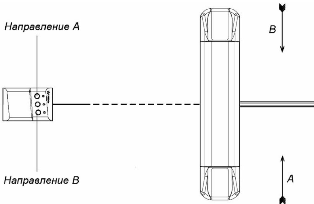
**Рисунок 8. Стандартная ориентация ПДУ относительно стойки турникета**
