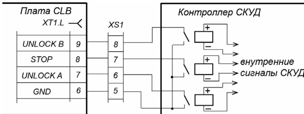
**Рисунок 6. Управляющие элементы внешнего устройства – нормально разомкнутый контакт реле**
