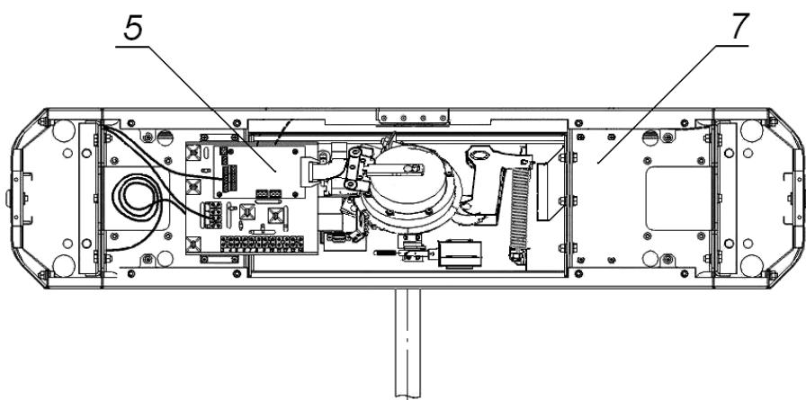
**Рисунок 10. Схема прокладки кабелей в стойке турникета**
