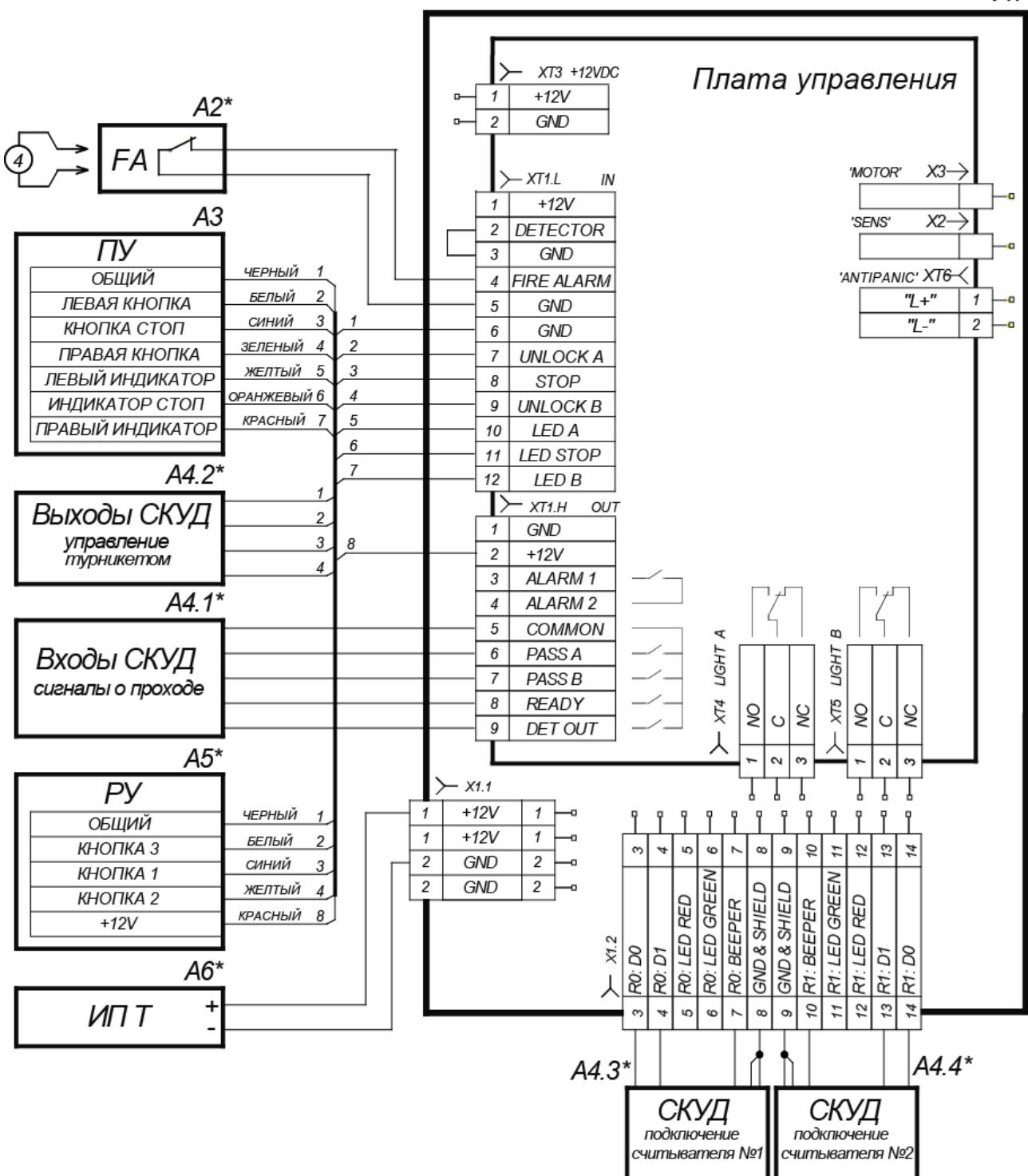
Рисунок 11. Схемы соединений турникета и дополнительного оборудования<sup>1</sup>
