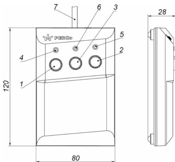
Рисунок 4. Общий вид и габаритные размеры ПДУ
