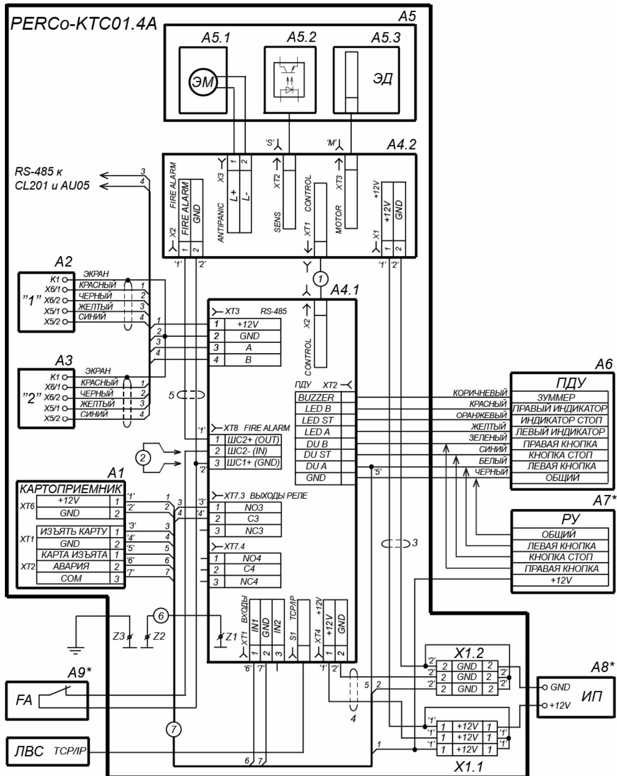
При установке картоприемника со стороны считывателя №2 необходимо переключить выход картоприемника '5' с контакта **DU A** на контакт **DU B** разъема **XT2**
