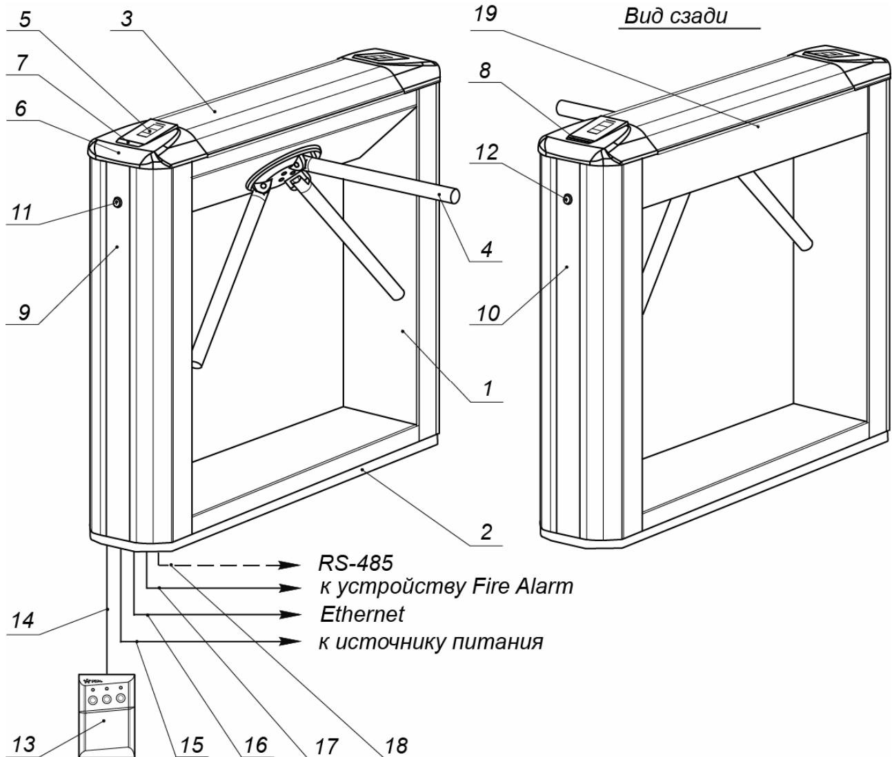
**Рисунок 2. Устройство ЭП**
