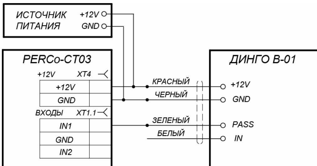
Рисунок 16. Схема подключения алкотестера «Динго В-01» (ООО СИМС-2)
