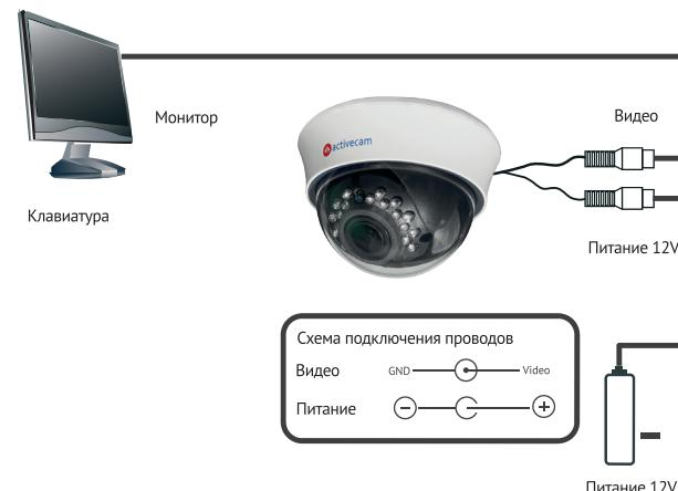
Данная камера имеет три режима работы с разрешением 1Мп: TVI, AHD и CVI, а также режим аналогового видео стандарта CVBS (PAL 960H) с разрешением 700ТВЛ. По умолчанию камера работает в стандарте TVI1.0. Для переключения в другие режимы удерживайте кнопку ВНИЗ OSD-джойстика: в течение первых 5-ти секунд камера переключится в режим AHD, при дальнейшем удержании в течение 5-ти секунд - в режим TVI2.0, еще через 5 секунд - в режим CVBS, а при дальнейшем удерживании - в режим CVI.
