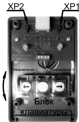
Вид пульта со снятой крышкой
