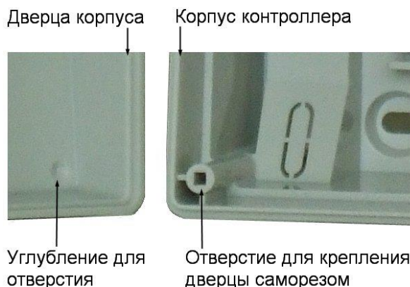
Рисунок 5. Система «жесткого» крепления дверцы к корпусу контроллера
