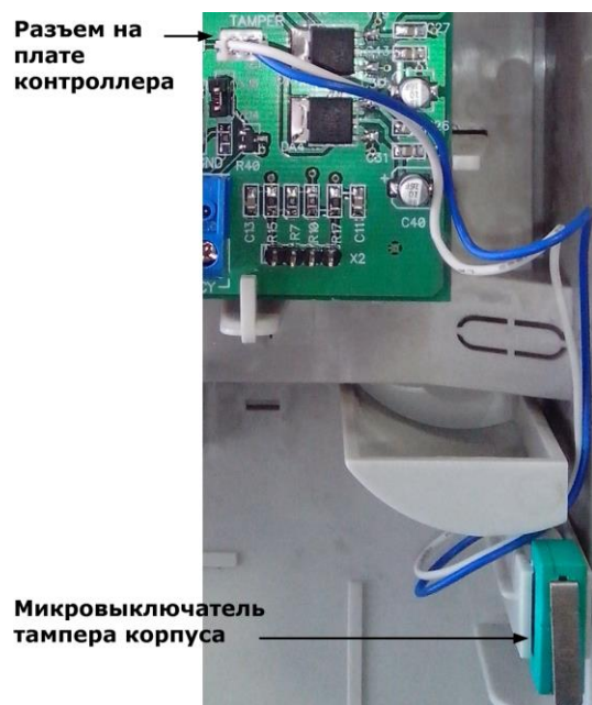
Рисунок 22. Подключение тампера корпуса
