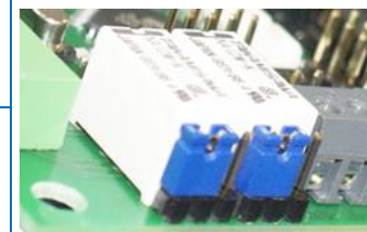
Контакты реле PAS нормально разомкнуты (состояние поставки)
