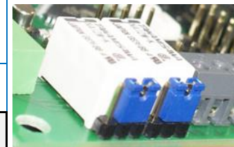
Контакты реле PAS нормально замкнуты
