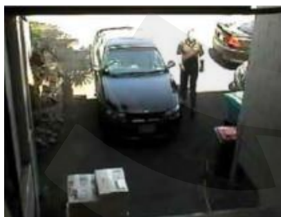
Функция компенсации задней засветки выключена. При резком контрасте света и тени объекты не распознаваемы.
