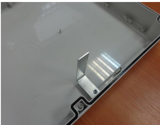
Рис. 2.5-2. Шторка датчика вскрытия на крышке блока
