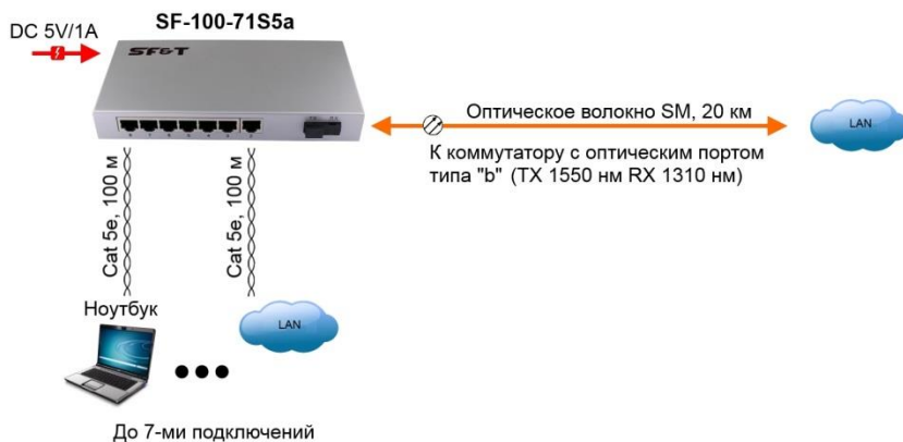
Рис. 4. Схема подключения коммутатора SF-100-71S5a
