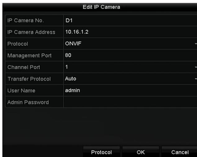
Рисунок 2.34 Редактирование параметров IP-камеры
