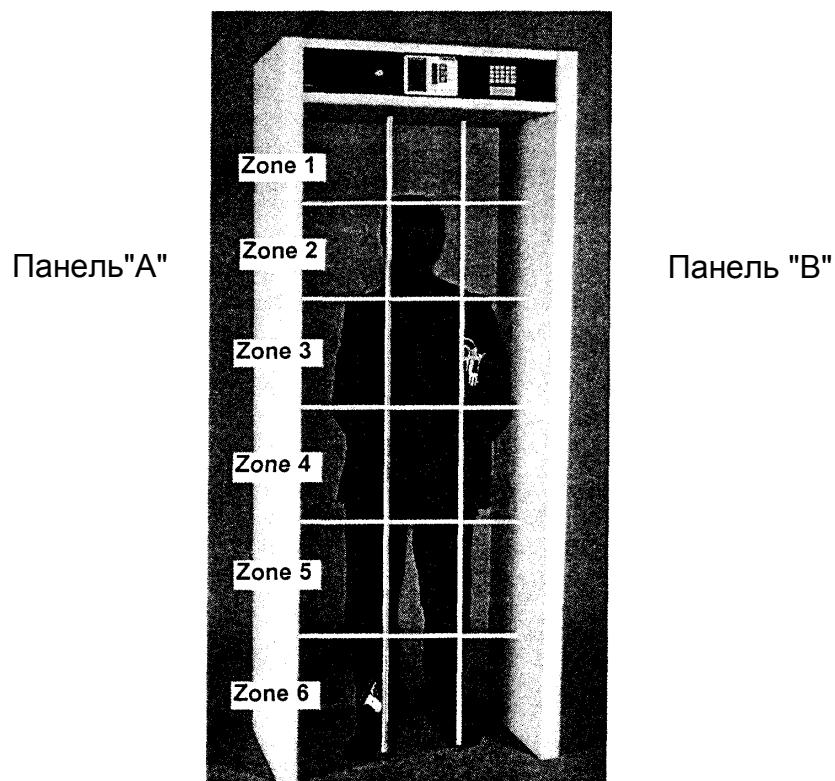
Освободите разъемы панелей от предохранительной изоляции и подсоедините к ним провода центрального блока, зафиксировав их винтами. Соберите конструкцию, используя имеющиеся в комплекте болты и ключ. Присоедините к нижнему разъему панели сетевой шнур и подключите его к розетке электропитания.
