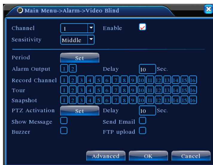
Рис. 4.9 Настройка маскирования камер
