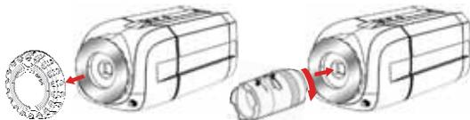
\* Зафиксируйте объектив после его установки, сохраняя угол.
