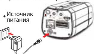
\* Камера может работать от постоянного тока 12В или PoE в зависимости от модели которую вы купили.
