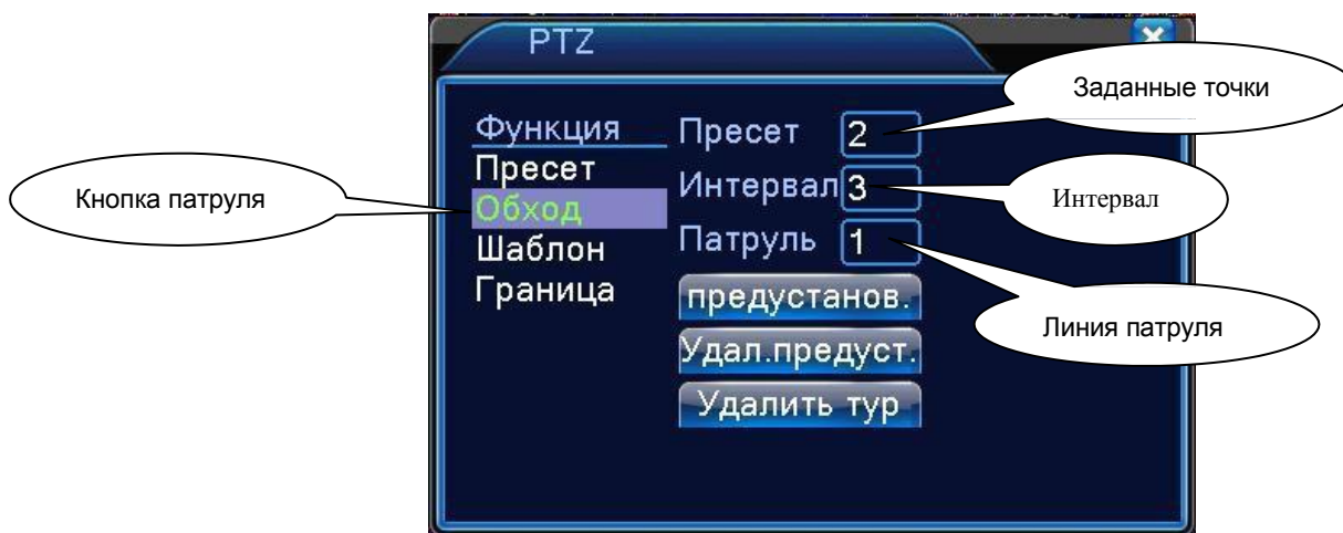
Рисунок 3.13 Настройки движения между точками
