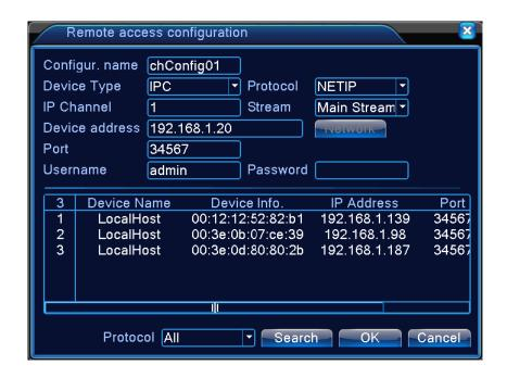
【Поиск】 Поиск и отображение IP-адреса в предалах одной локальной сети, например IPC, DVR и NVR. Виберите один IP-адрес, имя устройства, тип, IP-адрес, порт и протокол будет введен автоматически.
