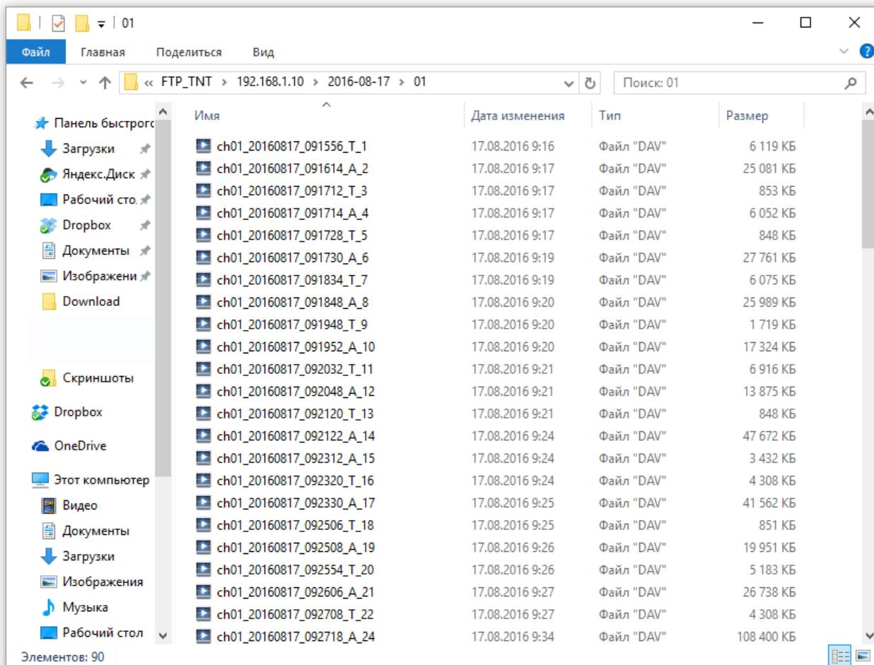
Камера записывает видеофайлы на FTP сервер в специальном формате, совместимом с многоканальным форматом записи видеорегистраторов, поэтому для чтения файлов необходимо использовать ПО TS VMS из комплекта поставки камеры.
