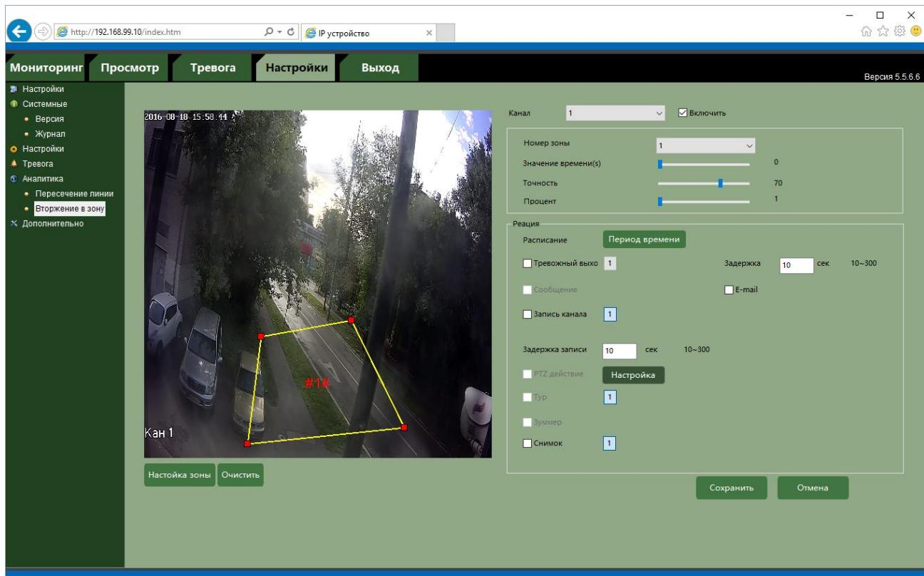
Камера позволяет включить до 4-х детекторов вторжения с различными настройками.
