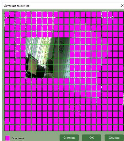
Зона, закрашенная фиолетовым цветом, используется для детектирования движения, в не закрашенной зоне детектирование движения не производится.
