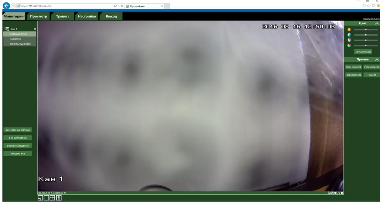
Выберите **Главный поток** или **Субпоток** для трансляции и в браузере появится изображение, транслируемое камерой. При этом в центрально части находится изображение, получаемое с IP-видеокамеры, а в верхней части – основное меню настроек. Внизу и справа находятся кнопки управления дополнительными функциями.
