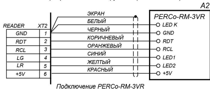
Рисунок 2. Схема подключений к контроллеру
