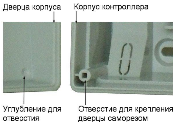
Рисунок 6. Схема «жесткого» крепления дверцы к корпусу контроллера
