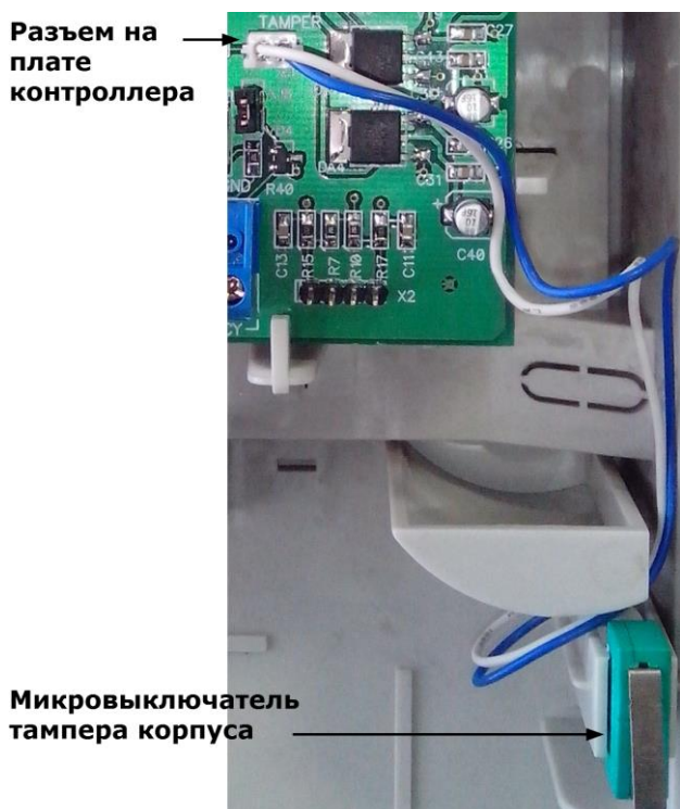
Рисунок 24. Подключение датчика вскрытия корпуса
