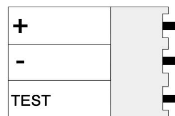
Рисунок 3. Назначение контактов разъема POWER
