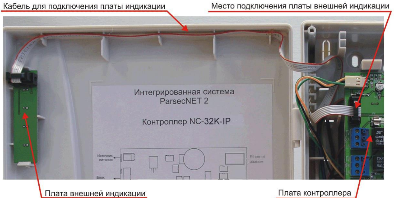
Рисунок 28. Схема подключения платы внешней индикации
