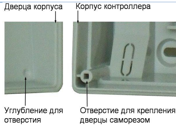
Рисунок 5. Схема «жесткого» крепления дверцы к корпусу контроллера
