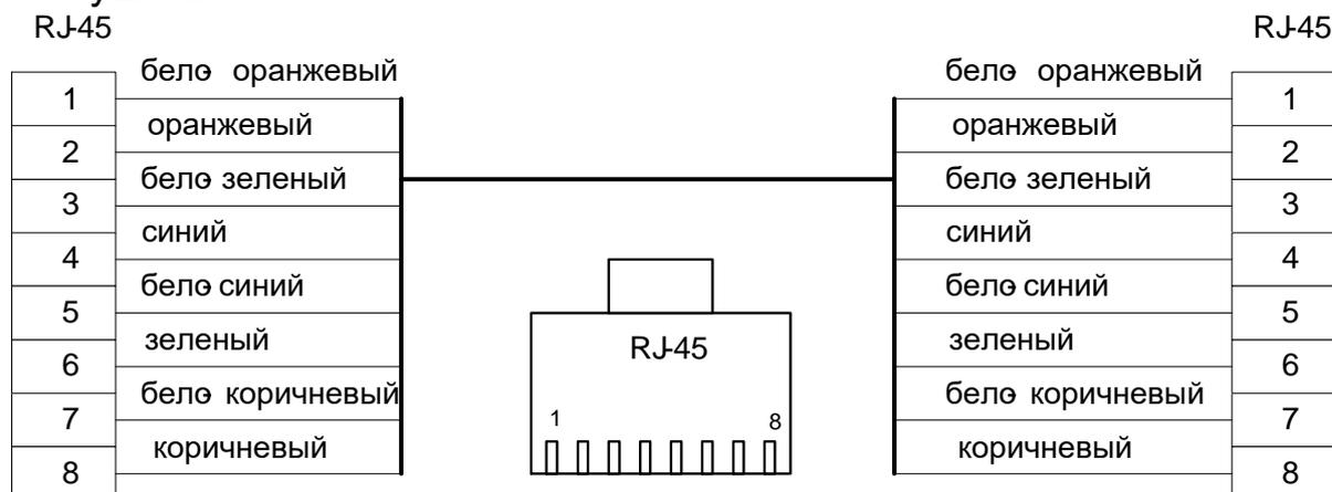
Рис. 5.4. Разделка Ethernet кабеля.
