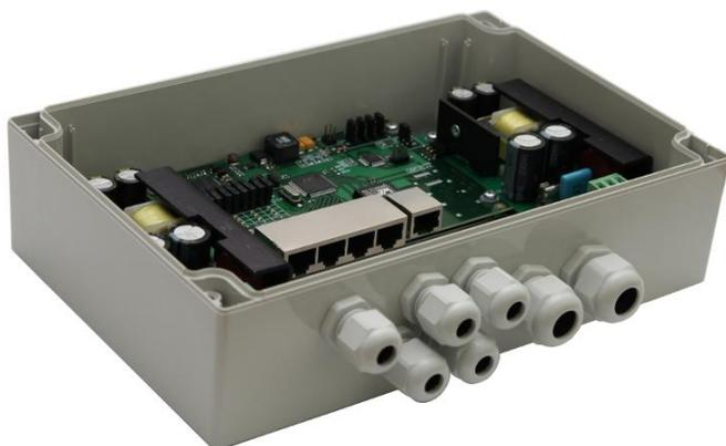
Рис. 2.1-3. PSW-1-45 - вид внутри
