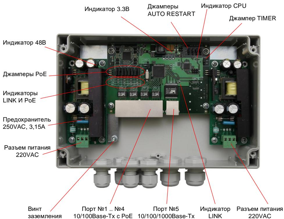
Рис. 2.2-2. Расположение элементов PSW -1-45
