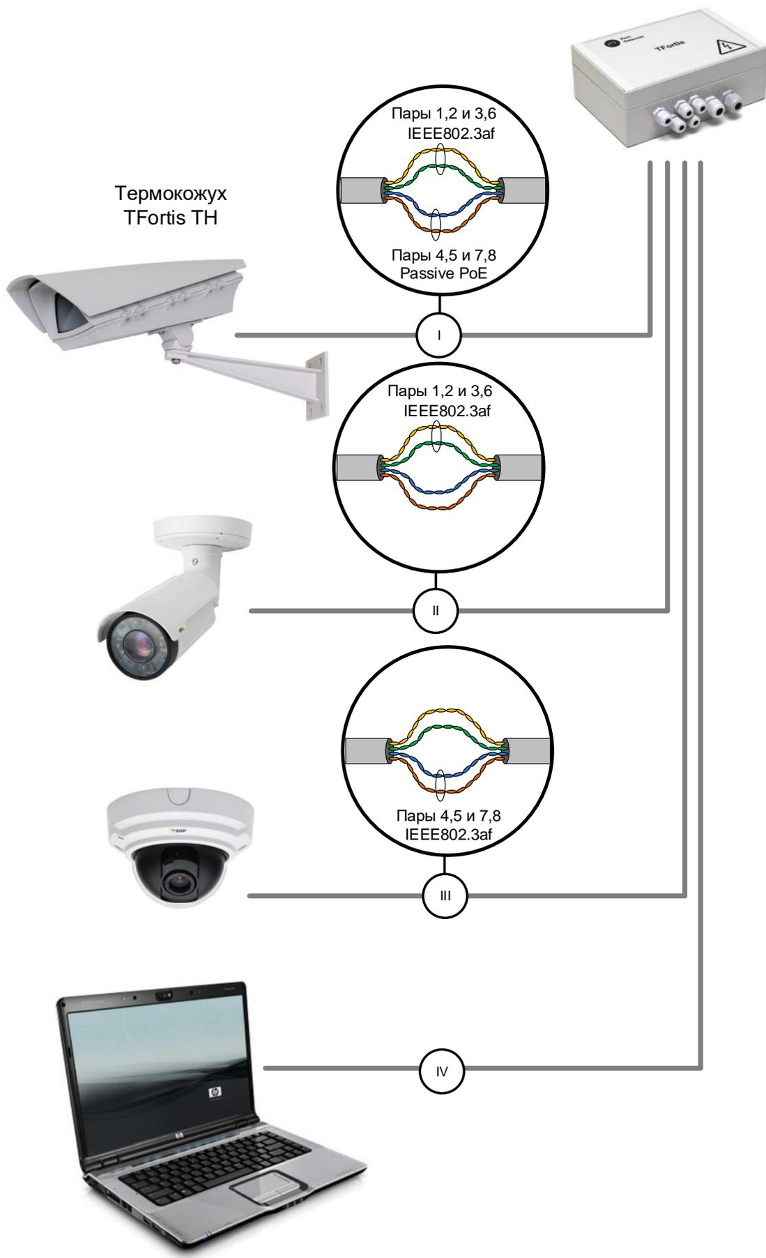
Рис. 2.3. Схема питания по PoE для разных случаев
