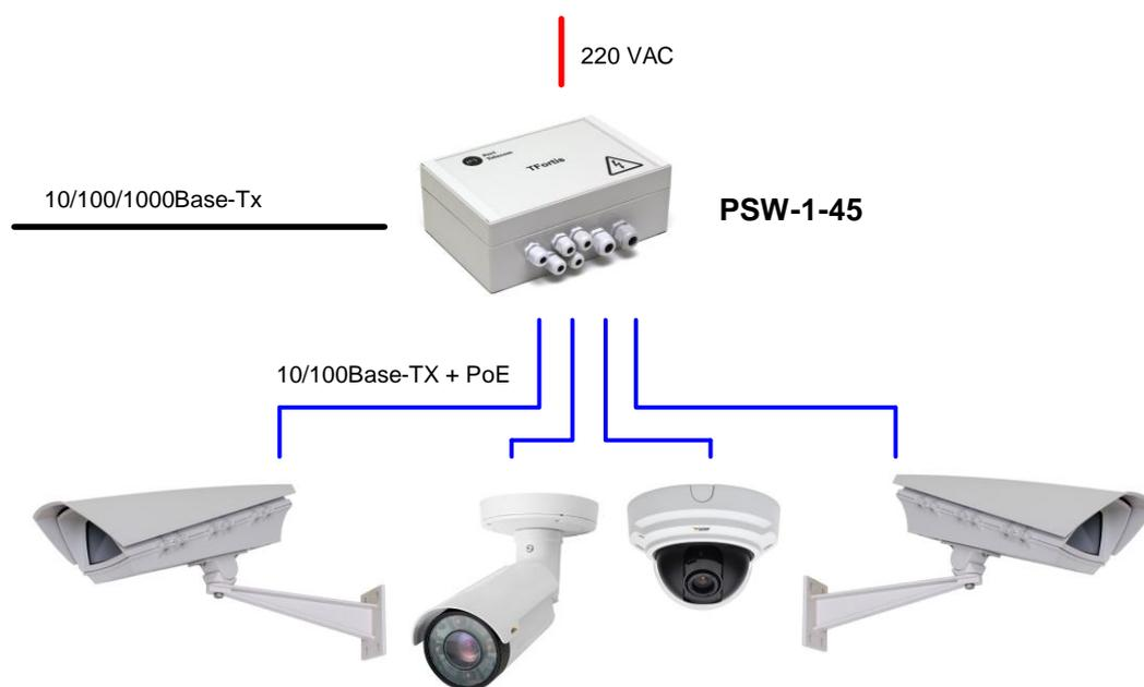
Рис. 1-2. Схема подключения PSW-1 по меди
