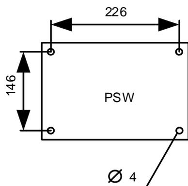
Рис. 5.1.1. Разметка крепления
