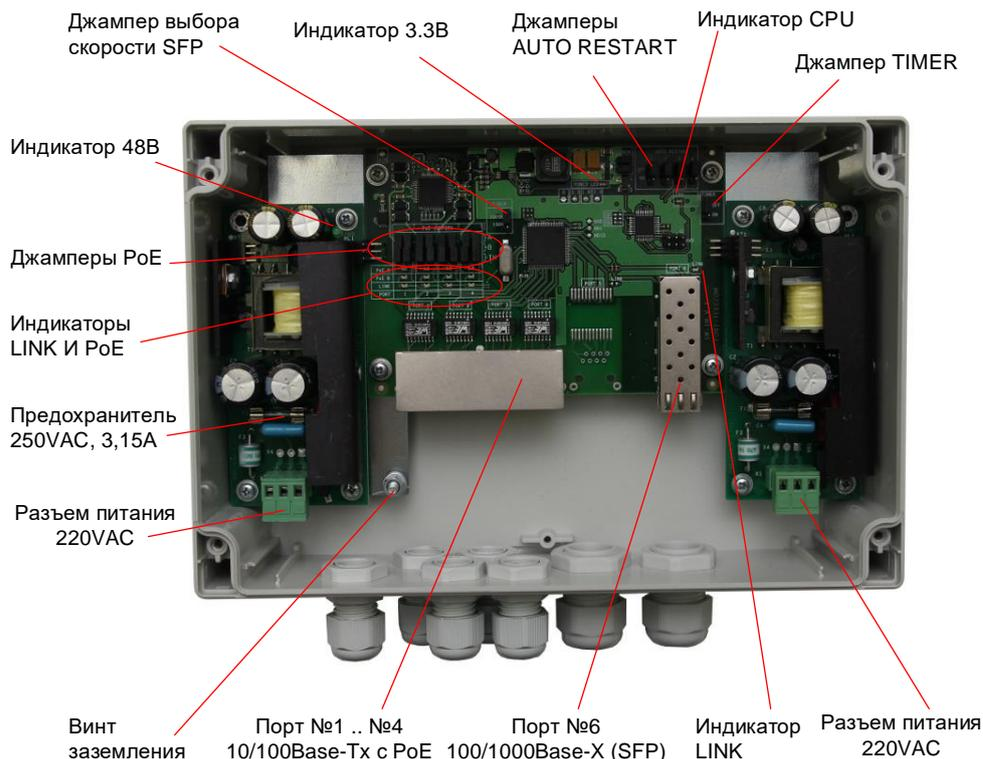
Рис. 2.2-1. Расположение элементов PSW -1
