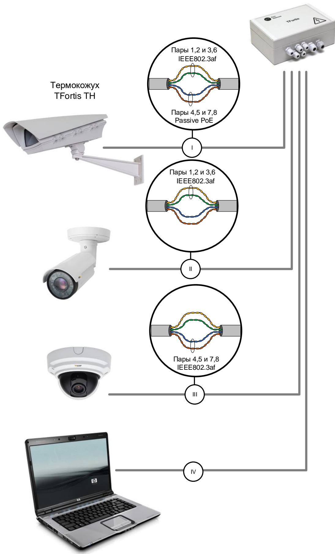
Рис. 2.3. Схема питания по PoE для разных случаев
