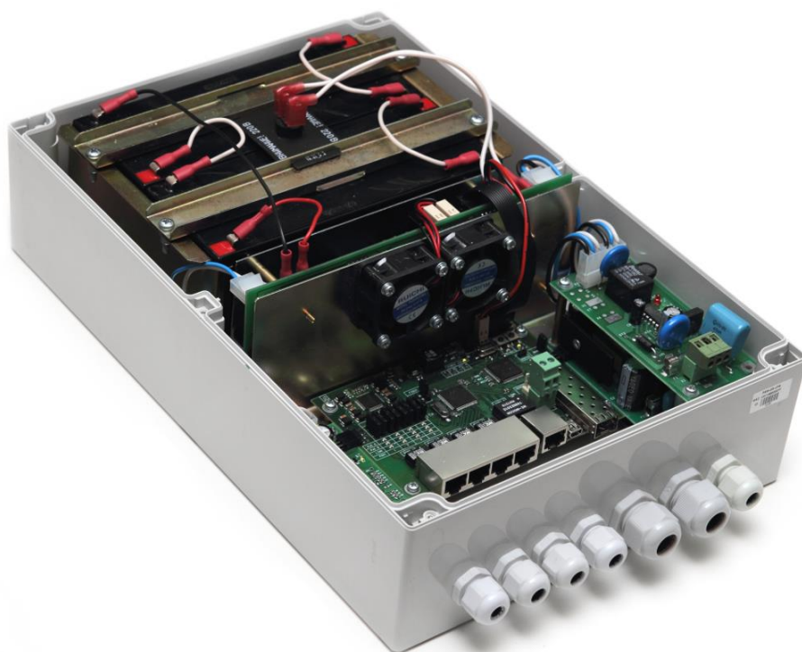
Рис. 2.1-5. PSW-1G4F-UPS - вид внутри
