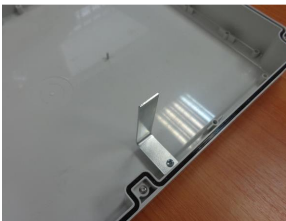
Рис. 2.5-2. Шторка датчика вскрытия на крышке блока
