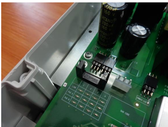
Рис. 2.5-1. Датчика вскрытия на плате
