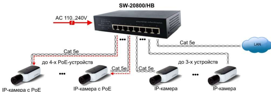
Рис. 3 Схема подключения коммутатора SW-20800/НВ
