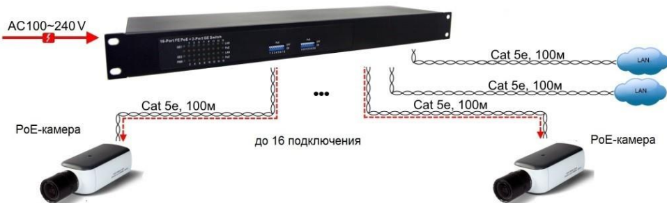
Рис. 8 Схема подключения SW-21620/B
