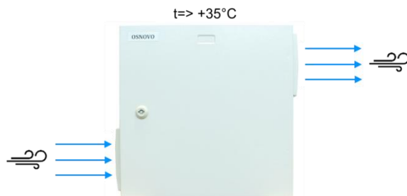
Рис. 27 Принцип работы системы проточной вентиляции
